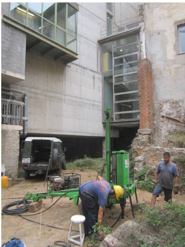
19. Operaris realitzant el sondeig geotècnic a la zona del sondeig 4
